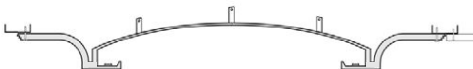
Schéma de principe d'une coupole semi-encastrée
